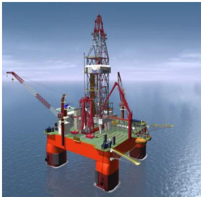
Yarımdalma üzən qazıma qurğusu Полупогружная буровая установка Semi submersible drilling rig
