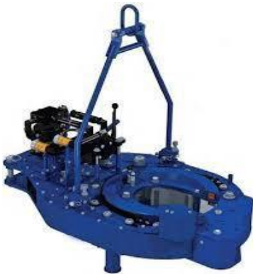
Avtomatik qazıma açarları Автоматические буровые ключи Automatic drill tongs
