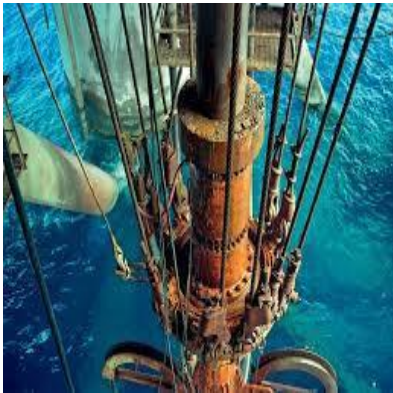
Suayırıcı kəmərlər,dəniz rayzeri Водоотделяющая колонна, морской стояк Marine conductor,subsea riser
