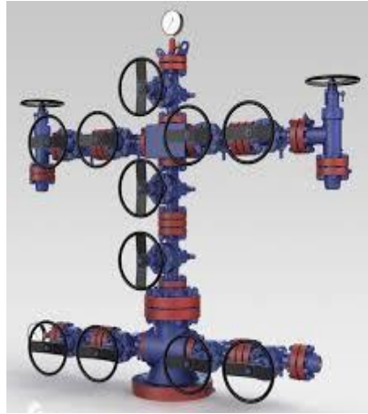
Хаçварı (дöрдбоғаз) fontan armaturu Крестовая фонтанная арматура Christmas tree- wellhead assembly
