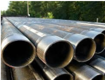
Qoruyucu boru Обсадная труба Casing
