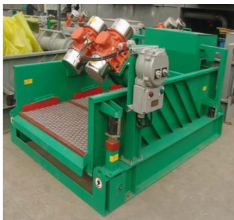
Titrəyən ələk-qazıma məhlulu üçün Вибросито для бурового раствора Mud shale shaker
