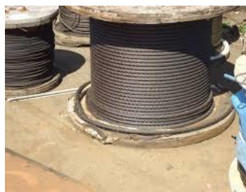
Tal kanatı Талевый канат Drilling line
