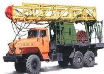
Əsaslı təmir maşını АЗИНМАШ-37А1 Автомашина капремонта АЗИНМАШ-37А1 АЗИН- МАШ-37А1overhaul truck
