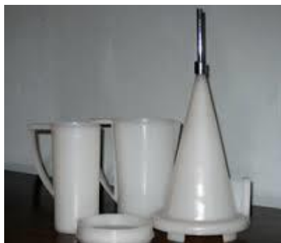
Şərti özlülüyü ölçən qif Воронка для раствора Funnelbor solution viscosity
