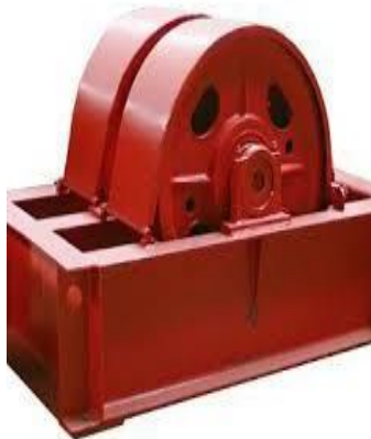
Kronblok Крон блок Crown block
