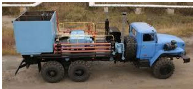
Sementləmə aqreqatı-ЦА-400 Цементировочный агрегат- ЦА-400 Cementing unit - ЦА -400
